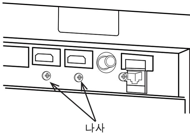
그림과 같이 제공된 HDMI 케이블 홀더와 케이블 타이를 사용해 HDMI 케이블이 빠지지 않도록 고정하는 것이 좋습니다. 2.0 x 4.0mm 이하 크기의 케이블 타이 를 사용하십시오.
