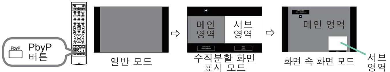
리모컨의 PbyP 버튼을 누릅니다 . 수직분할 화면 표시 모드를 활성화합니다 . 그런 다음 PbyP 버튼을 다시 누릅니다 . 프로젝터가 화면 속 화면 모드로 전환됩니다 . PbyP 버튼을 누르기 전에 표시되었던 화면이 메인 영역으로 표시됩니다 . 대부분의 조작은 메인 영역에 대해서만 유효합니다 . 메인 영역에 대해서 화상 입력 신호와 짝을 이루는 오디오 입력 신호만을 출력합니다 . 화면 속 화면 모드를 종료하려면 PbyP 버튼을 다시 누릅니다 .
